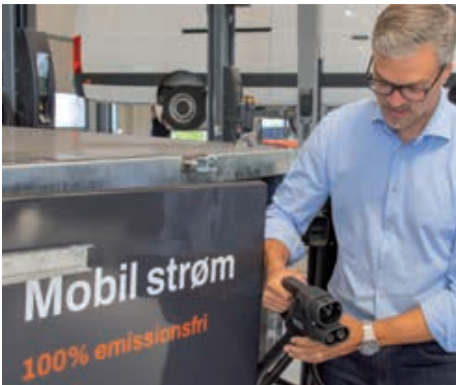
Her står Kristoffer Qvist ved en batteritrailer, Renteq har udviklet, og som betyder, at eldrevne entreprenørmaskiner kan blive ladet op på en byggeplads. Foto: Kirsten Marie Juel Mouritsen
